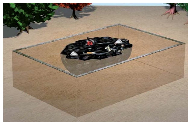
Realizace podzemních těsnících stěn (geokontejntentu) pro zamezení šíření znečišťujících látek a/nebo pro úpravu hydrogeologických podmínek kontaminovaného ložiska
