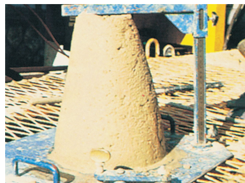
Sednutí kužele injektované směsi
